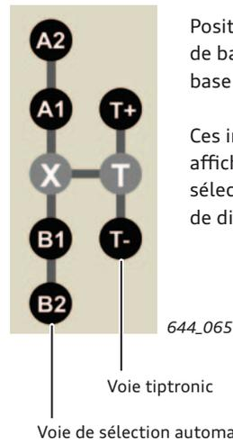
Positions possibles du levier sélecteur. Position de base X en mode automatique ou position de base T en mode tiptronic.
