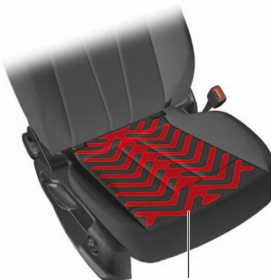
Capteur d'occupation du siège, côté passager avant G128 644\_013
