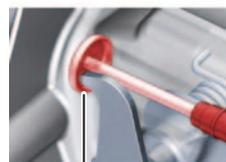
Fixation du câble de déverrouillage de secours sur la boîte ODS
